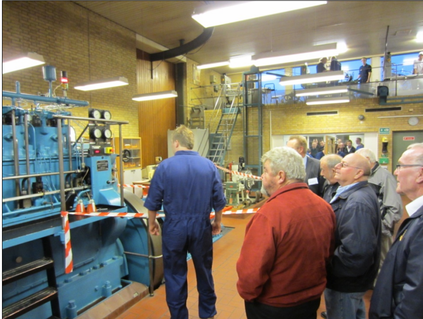
Fra besøget på SIMAC Den gamle B&W hjælpemotor startes op.
